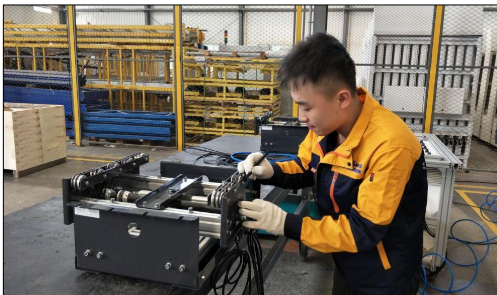
图 安装调试顶升移栽机
