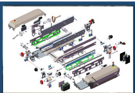
智能化仓储高速穿梭车三维建模
